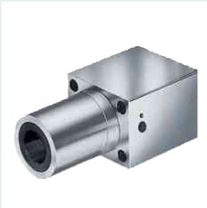
Set lineal R1083.., con brida Diámetro del eje 12–30 mm Carcasa embridada de precisión de aluminio (construcción ligera), con dos rodamientos lineales Super A con juntas integradas
