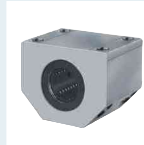
Set lineal R1701.. cerrado Diámetro del eje 20–60 mm Carcasa de precisión de aluminio (construcción ligera), con rodamiento lineal Super U o SE relubricable, con dos juntas
