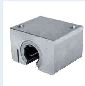
Set lineal R1038.. abierto, ajustable Diámetro del eje 12–50 mm Carcasa de precisión de aluminio (construcción ligera), con rodamiento lineal Super A o B , relubricable
