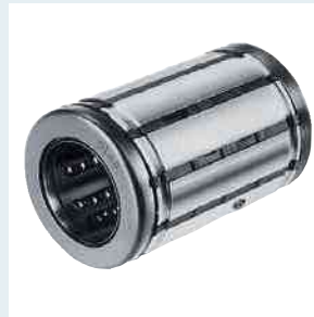
Rodamiento lineal Super SE R0730.. cerrado, con compensación de errores de alineación Diámetro del eje 20–50 mm Insertos portantes adicionales de acero con pistas de rodadura rectificadas, sin o con dos juntas integradas
