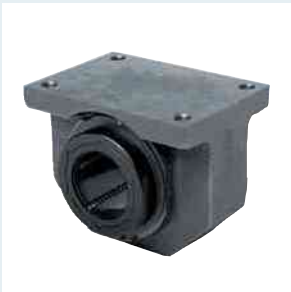
Set lineal R1065.. cerrado Set lineal R1066.. cerrado, ajustable Diámetro del eje 12–50 mm Carcasa de precisión de fundición de aluminio , con rodamiento lineal Super A o B con juntas integradas
