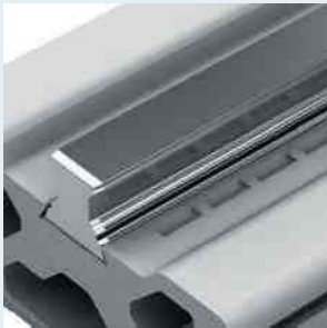
Raíl guía de bolas en V, retacado a la base, acero Tamaños 15-25 Sin taladros de fijación necesarios, fijación económica gracias a la reducción de tiempo de montaje. El alojamiento del raíl se puede fabricar con fresas de forma estándar.
