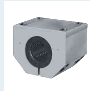
Set lineal R1702.. cerrado, ajustable Diámetro del eje 20–60 mm Carcasa de precisión de aluminio (construcción ligera), con rodamiento lineal Super U o SE relubricable, con dos juntas
