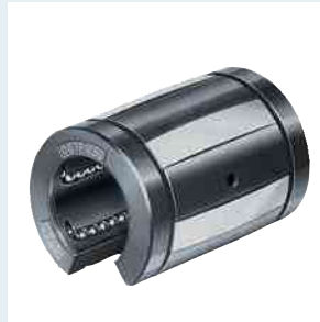
Rodamiento lineal Super A R0671.. abierto, con compensación de errores de alineación Diámetro del eje 12–50 mm Con o sin dos juntas integradas, o con dos juntas integradas y juntas longitudinales (completamente estanco)
