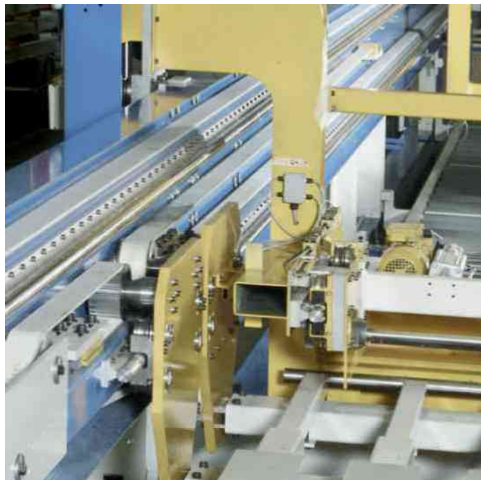
Eje de precisión de acero R0724 0, con cuatro ranuras, eje hueco
