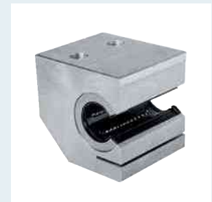
Set lineal R1072.. abertura lateral, ajustable Diámetro del eje 20–50 mm Carcasa de precisión de aluminio (construcción ligera), con rodamiento lineal Super A o B , relubricable, con dos juntas y juntas longitudinales (completamente estanco)
