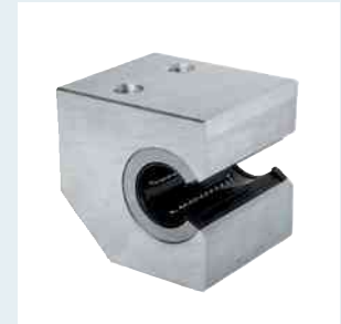
Set lineal R1071.. abertura lateral Diámetro del eje 20–50 mm Carcasa de precisión de aluminio (construcción ligera), con rodamiento lineal Super A o B , relubricable, con dos juntas y juntas longitudinales (completamente estanco)
