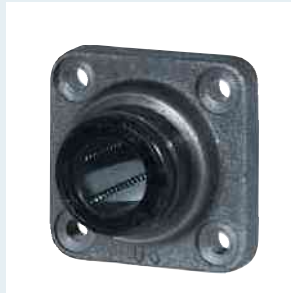
Set lineal R1081.., con brida Diámetro del eje 12–50 mm Carcasa embridada de precisión de fundición gris , con dos rodamientos lineales Super A o B con juntas integradas
