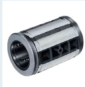
Rodamiento lineal Super U R0732.. cerrado, con compensación de errores de alineación Diámetro del eje 20–60 mm Hileras de bolas adicionales para una mayor capacidad de carga, pistas de rodadura rectificadas, sin o con dos juntas integradas
